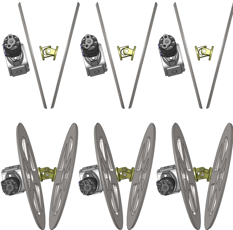
Figur 5-5. Konceptförslag 5, hydraulmotor med centrumknut.
