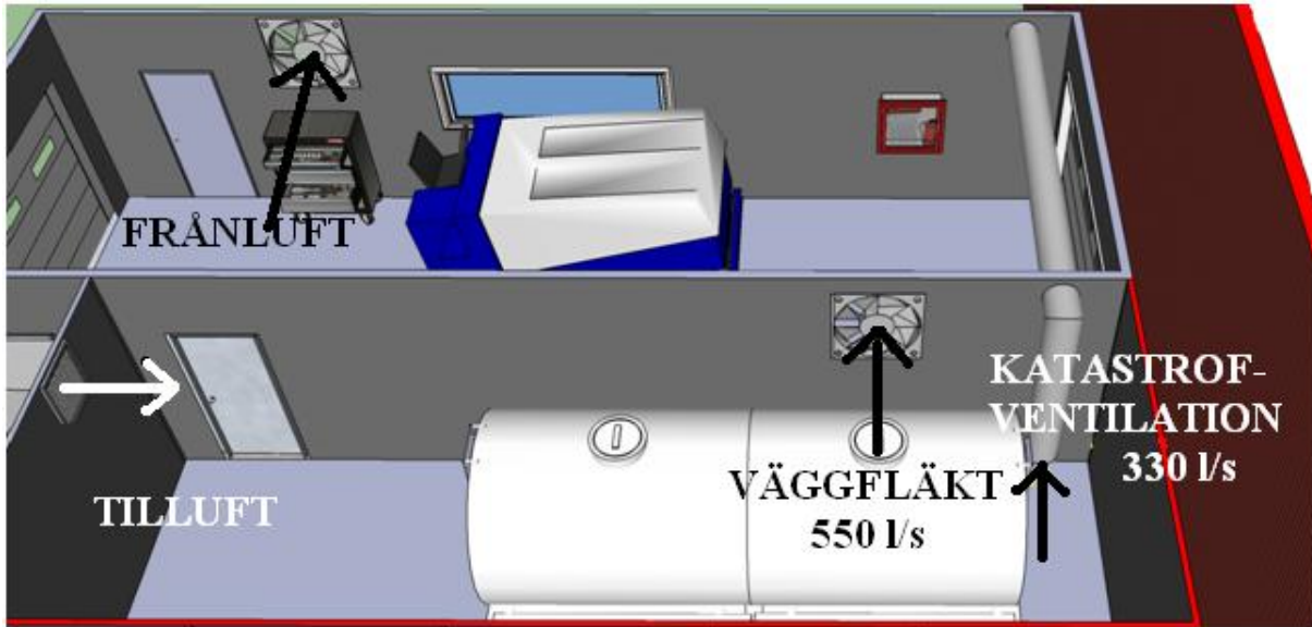
Figur C.2 - Principskiss över ventilationsflödena i frysmaskinsrummet.
