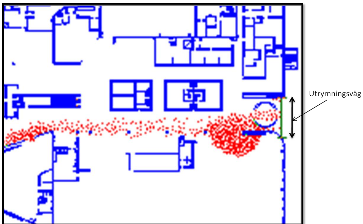
Figur 19. Simulering i Simulex som visar flödet genom huvudentrén där några begränsningar i programmet syns. Till exempel kan det bildas orimliga köer runt hörn. Området till höger i bilden motsvarar det fria utomhus.
