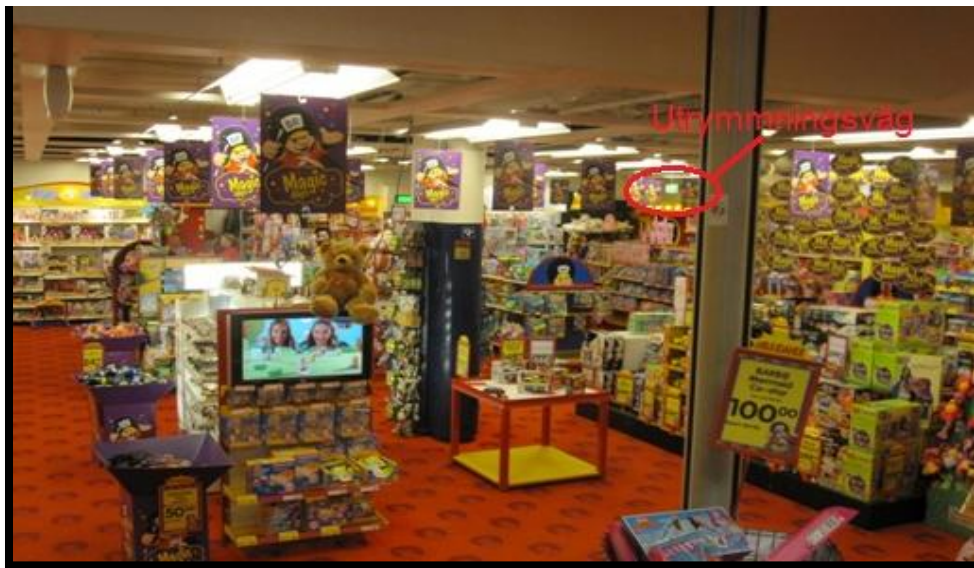
Figur 7.9 Bild över skyltar som skymmer utrymningsdörren. Bilden är tagen från ingången till BR Leksaker.
