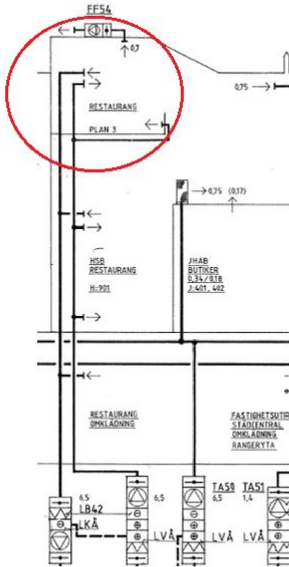
Figur 8.3 Översikt över ventilationen på delen som påverkas vid brand i restaurangen på Pergola. Röd ring är Pergola.
