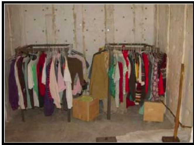
Figur 7.6 Försöksuppställningen som den dimensionerade branden på BR Leksaker utgår ifrån (Bwalya, Zalok, & Hadjisophocleous, 2007).
