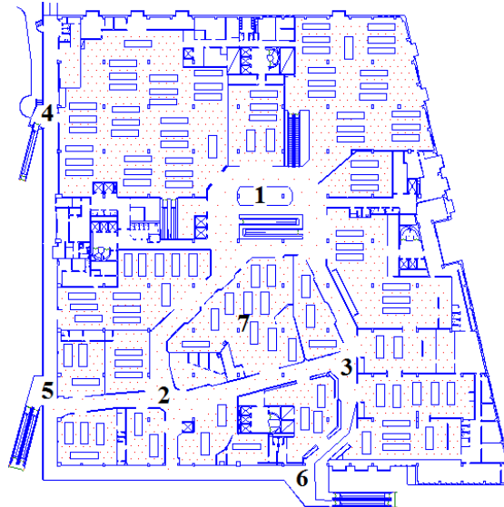
Figur 19. Uppställningen för Simulex simuleringen med de utvalda punkterna på plan 3.
