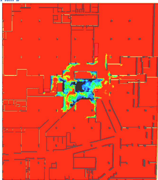
Figur 54. Sikt efter 230 sekunder i Scenario IIB, Plan 3
