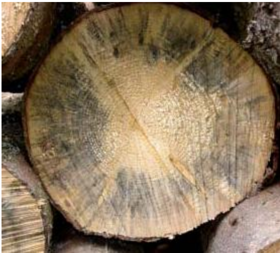
Figur 13. Bilden visar hur det ser ut då stocken angrips av djupgående stockblånad. (Ekstedt, Karlsson, 2009)
