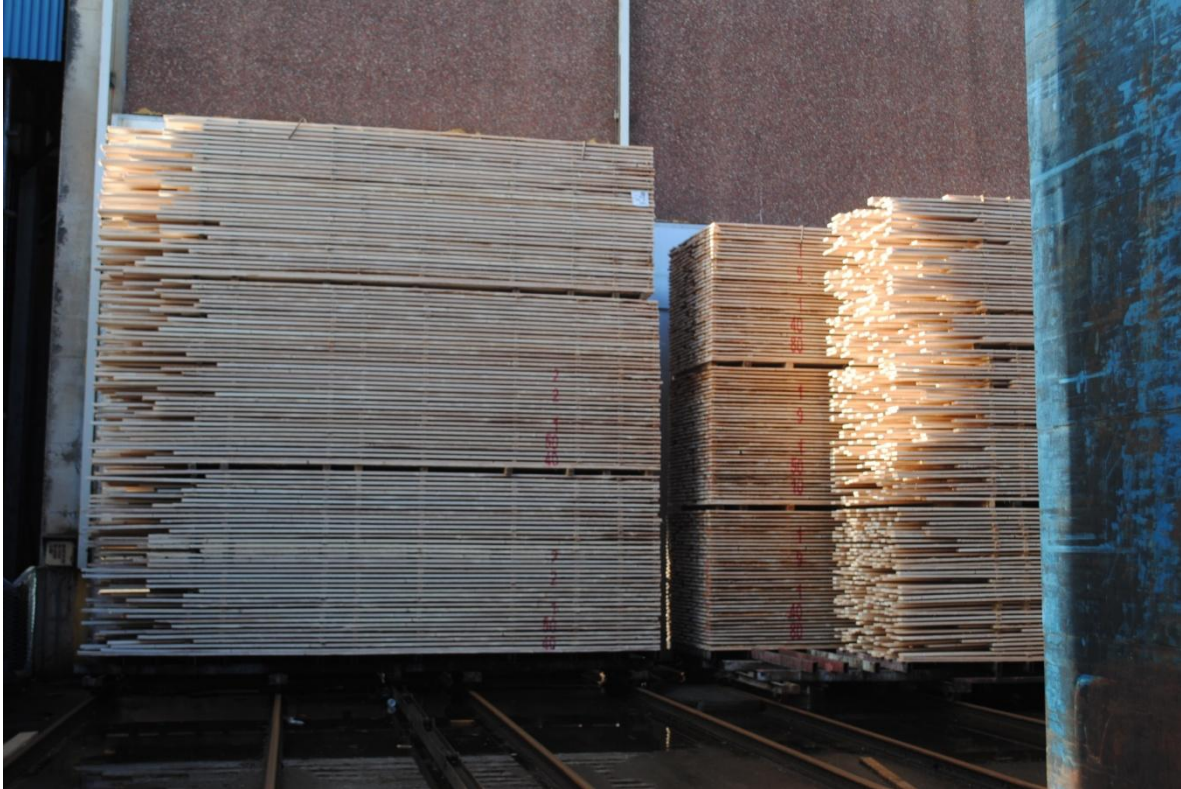
Figur 7. Virke på väg in i vandringsstorken under ett platsbesök på sågverk A. Här syns strölägningen mellan virkesstyckena.
