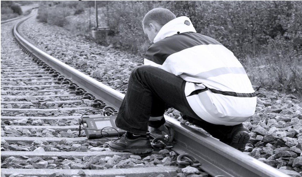
Figur 10 Bild på manuell ultraljudning av räl (Expose)
