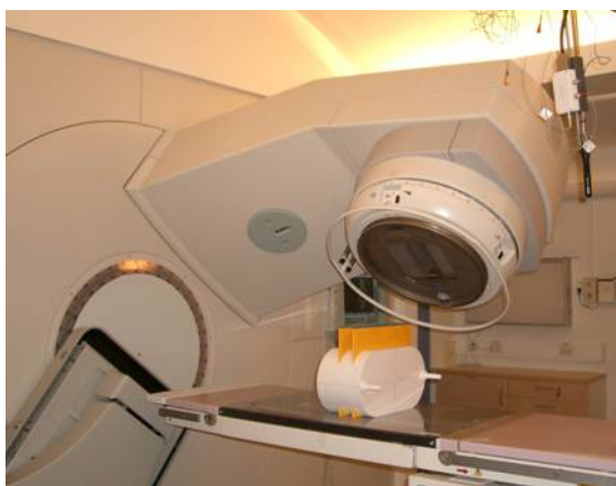
Figur 1. Figuren visar ett fantom innehållande två filmer som bestrålas med en linjär-accelerator.
