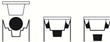
Figur E:4 – Ett godtycklig avföringsmängd förs, via patientprovskeden, över till mot-tagningsutrymmet. Väl där stansas en specifik mängd prov ut som slussas vidare i produkten.
