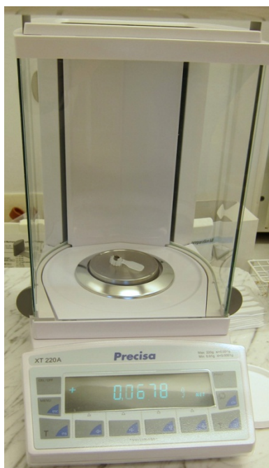
Figur A:2 – Fotografi på en digitalvåg – används för att mäta upp precis provmängd.
