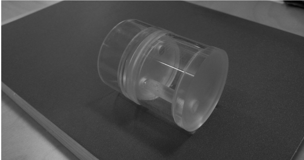
Figur H:1:2 – Hela den sammansatta modellen har yttermått: D=50\text{mm} & L=65\text{mm}
