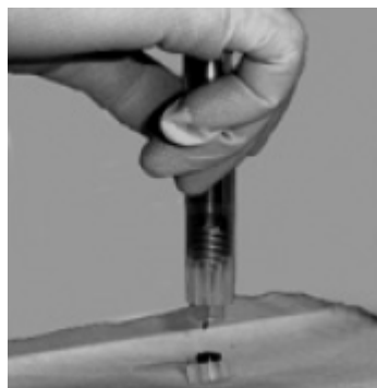
Figur 8 – Provröret trycks ner över botten och fäster tätslutande över denna. På bilden ses även den spiralfjäder som är monterat i provröret, fjädern vars spets sticker ut ur provrörets botten.
