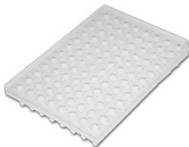
Figur 2 – Mikrotiter-platta med 8x12 brunnar
