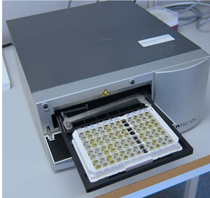
Figur A:7 – En bild på Eurodiagnostics spektrofotometer som används för att erhålla absorptionsvärdena i ELISA-matrisens brunnar.
