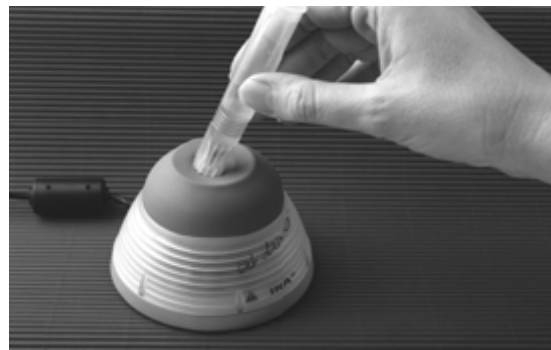
Figur 10 – Provmängden löses upp i bufferten genom att den vibreras i en Vortexapparat enligt bild, alternativt skakas i maskin som beskrivet i Avsnitt 3.2.3.
