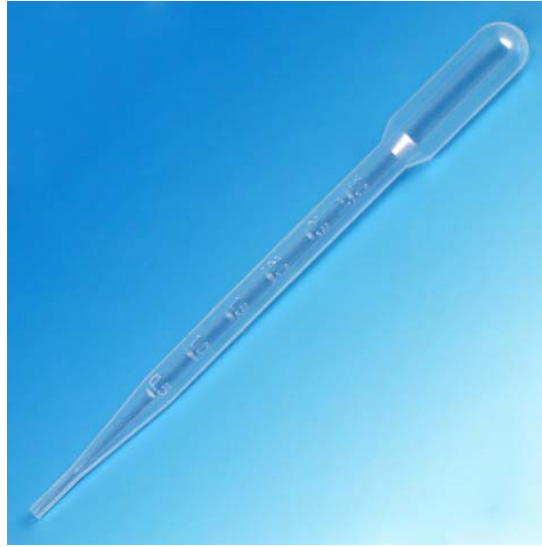
Figur A:5:2 – Pasteurpipett, används för att överföra färdigcentrifugerat extrakt till förvaringsprovror.
