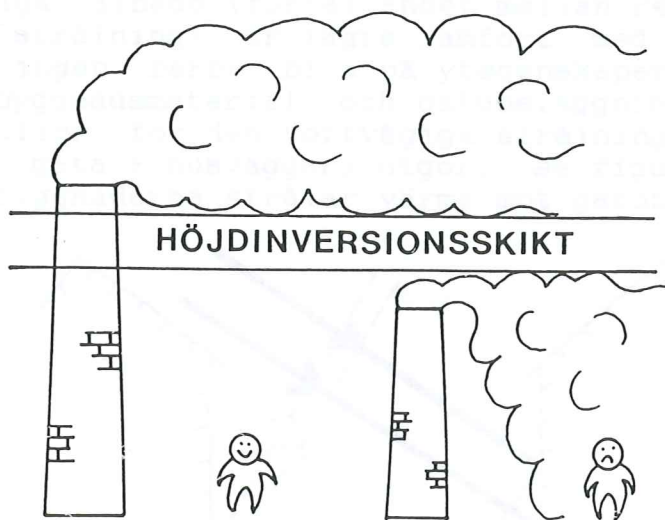
Figur 5. Utsläpp över och under ett inversionsskikt. Om skorstenen mynnar under skiktet blir det mycket höga koncentrationer av luftföroreningar i de lägre nivåerna. Mynnar skorstenen ovanför skiktet hindras luftföroreningarna från att nå marken. Rök som avges i själva inversionsskiktet kan vid inversioner följas som en tunn strimma kilometer-vis, ibland tiotals kilometer.
