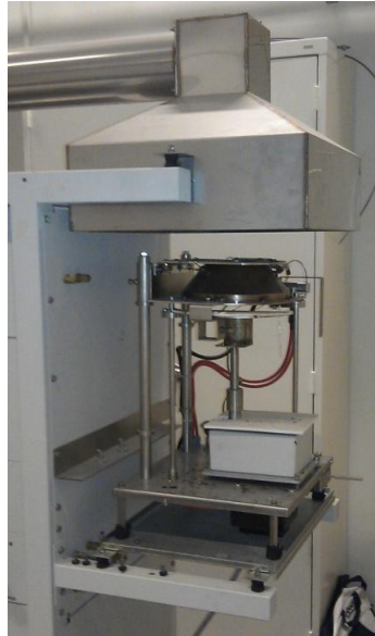
Figur 2.2. Försöksuppställning för ISO 5660 Konkalorimeter. Foto: Författaren.
