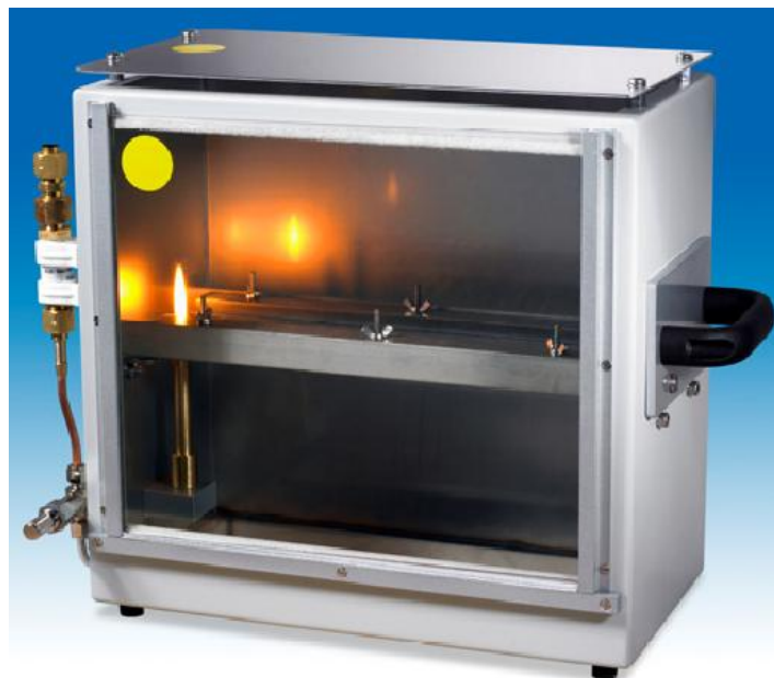
Figur 2.1. Försöksupställning för ISO 3795/FMVSS 302. Reproducerad med tillstånd från FTT.
