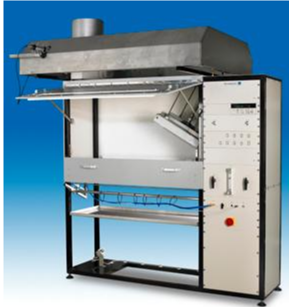
Figur 2.3. Försöksuppställning för EN ISO 9239-1. Reproducerad med tillstånd från FTT.
