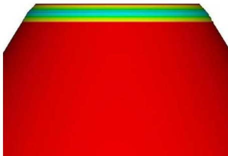
Figur 4-7 Illustration av begynnande buckling vid axiell trycklast. Figuren visar en förstoring av munstyckets inlopp. Här syns en "krag" där munstycket släpper från fixturen.
