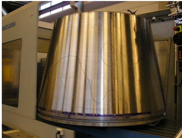
Figur 5-4 Undre delen av munstycket uppsatt i fixturen, efter lokalisering av upphöjningarna. De områden som är märkta med X är inte i kontakt med fixturen.
