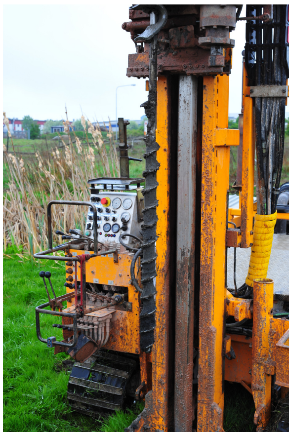
Fig. 8. Bild från skruvborrning med Geotech borrhbandvagn. Jordprovet som följer med borren upp rensas från kontamineringar, loggas och prov till kornstorleksanalys från representativa djup tages.
