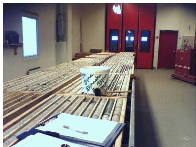
Figur 6. Karteringsbord i Boliden Mineral AB:s faciliteter. Notera skillnaden mellan vattenbeströdda (mörka) och torra kärnpartier. Kärnorna är 56 mm i diameter. (Foto Jonas Åker-
