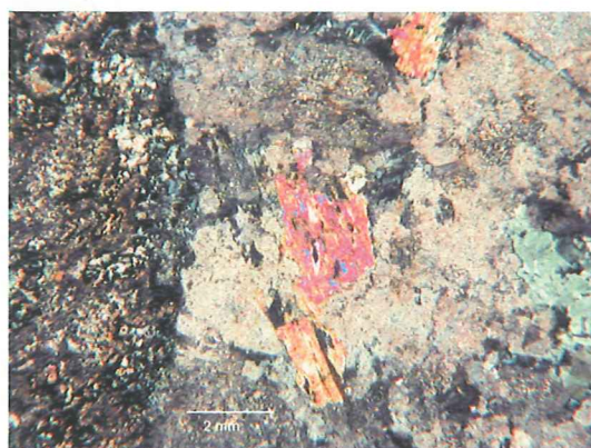
Fig 18 Matrix är medelkornigt och påminner i sin sammansättning om kärnan. Fältspat utgör den största delen av sammansättningen. De mörka mineralen, främst amfibol utgör ca 20%.
