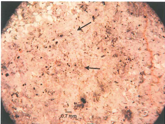
Fig 13 Det ljusa skalet består nästan uteslutande av starkt omvandlad fältspat. Amphibol och opaka mineral har ansamlats i tunna mörka band (markerade med pilar).
