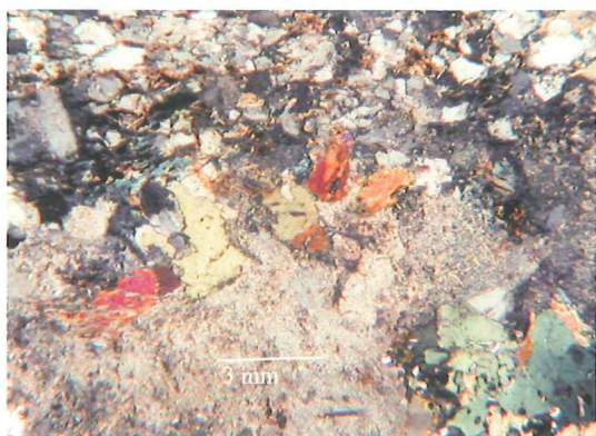
Fig 17 Övergången mellan det yttre mörka skalet och matrix syns tydligt i mikroskop. Kornstorleken ändras från finkornig till medelkornig och fältspaternas omvandling blir starkare.
