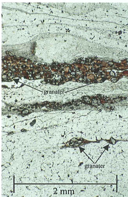
C. Granater som växer i ett matrix av biotit och sillimanit. Notera att granaterna är begränsade till detta matrix och saknas i omgivande kvarts och fältspat. Parallella nikoler.
