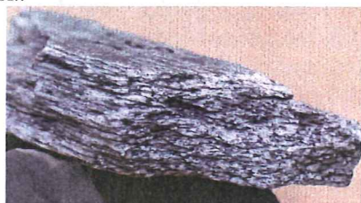
Fig. 7. Nallognejs varierar i utseende mellan att vara gnejsig/granitisk (A) och starkt förskiffrad (B). Höjden på provet i fig. B är ca 2.5 cm.
