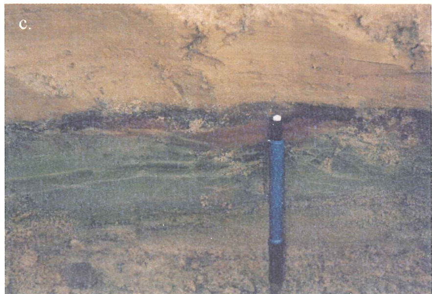
Figur 6. Litofaciesgrupp 1. 6a: Representativa prov på kornstorleksammansättning i F1-facies. 6b: Laminerad silt och siltig lera med inlagrad mindre sten. 6c: Järn- och manganutfällningar i oxiderad lera vid övergången till siltig sand.
