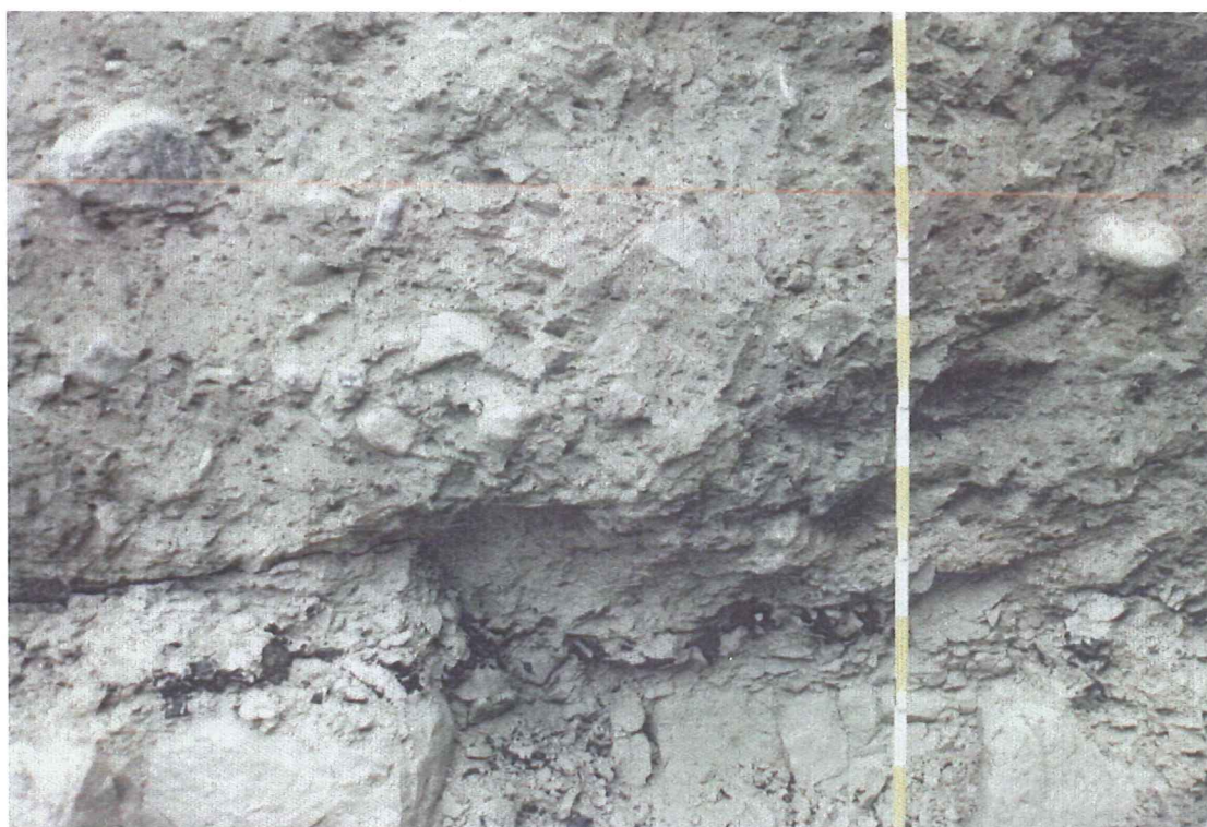
Fig. 21. Berggrundskontakten i skärning 2 del A. Den övre delen av berggrunden är sprucken och krossad. Detta skikt är mycket mäktigare några tiotal meter längre västerut. Den överlagrande diamiktonen är ljus och starkt präglad av den lokala berggrunden.
