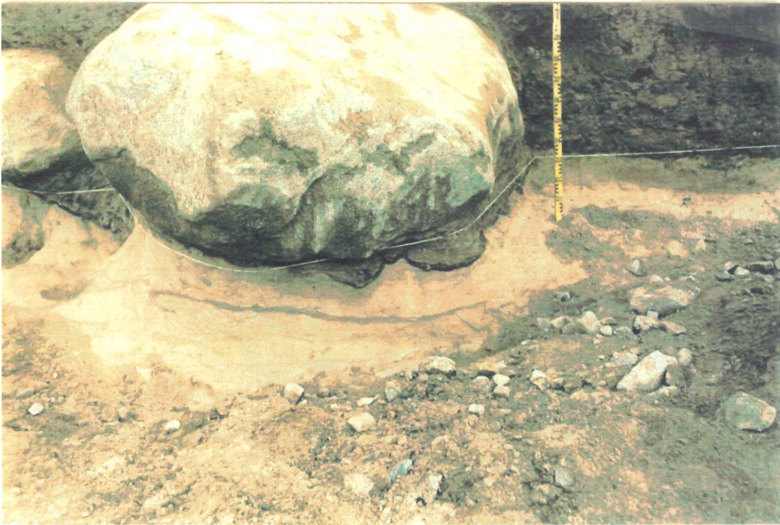
Fig. 8. Ett litet dike grävdes runt ett block vid 3 m. Den ljusa kalkberggrunden innehåller en horisontell, 2 cm mäktig siltfylld spricka. I kalkberggrundensöveryta finns en mörk järn- och manganrik horisont.
