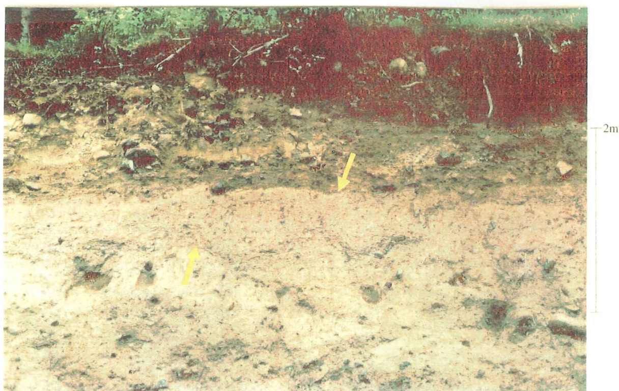
Fig. 20. Den skarpa kontakten mellan den grå siltiga-sandiga diamiktonen i enhet B3 och den bruna diamiktonen i enhet C. Även gränsen mellan enhet B2 och enhet B3 kan skönjas.
