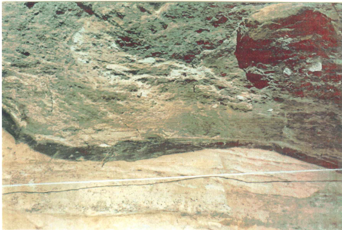
Fig. 28. Den svarta järn- och manganrika horisonten, samt den ovanpåliggande bruna diamiktonen (enhet B1). I övre högra hörnet syns en klotvittrad sten.
