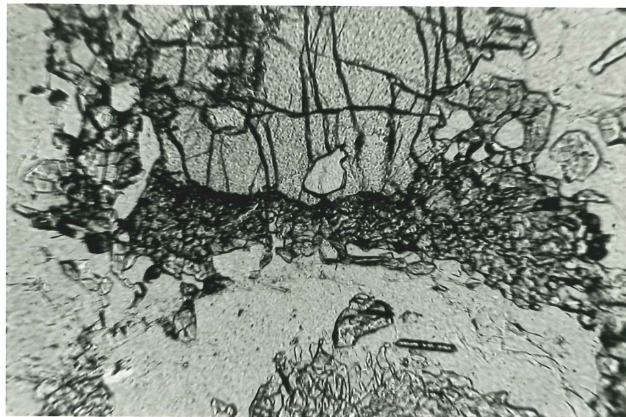
Fig. 12. Nedbrytning av klinopyroxen. Upptill klinopyroxen som bär en kant av ortopyroxen och plagioklas. Nedtill plagioklas. Skala: 1 cm = 95 \mu . Närbild ur tunnslip från lokal 3.
