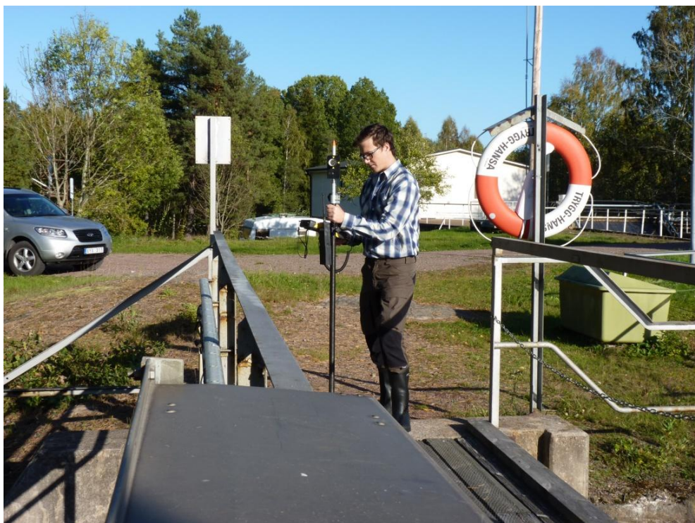
Figur 4-1 Författaren assisterar vid inmätning av dammkrön för befintlig damm med totalstation och prisma.
