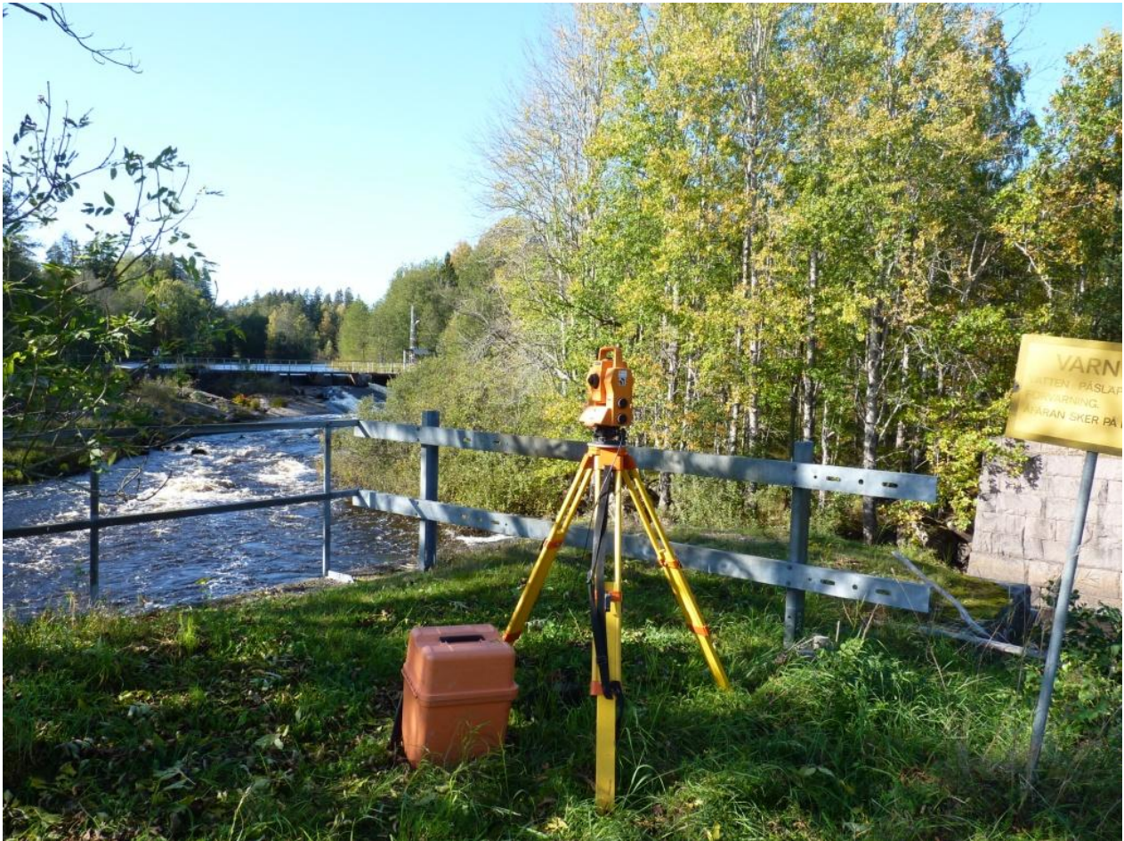
Figur 3-7 Totalstation av modell GDM 620 Pro placerad för inmätning av dammfix i bildens övre vänstra del.
