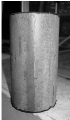
Figur 9: Provkropp med bitumentejp, 100 mm hög och 55 mm i diameter
