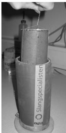
Figur 10: Provrör med provkropp och korg
