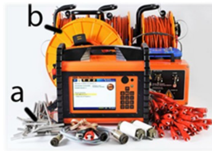
Fig. 12. ABEM Terrameter LS (mitten) – resistiviteitsmätinstrument – med elektroder (a) och ledarkablar (b) och annan tillhörande utrustning (ABEM Instrument AB 2012).
