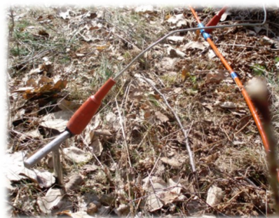
Fig. 6. Nedslagen elektrod inkopplad till en multiledarkabel vid en resistivitetmätning.
