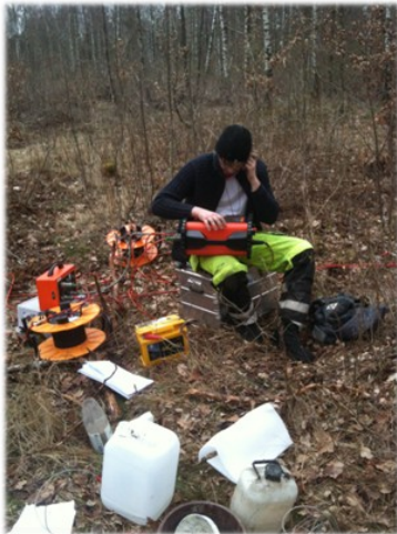
Fig. 15. Foto av upprättad mätstation med terrametern inkopplad till ledarkablar och övrig utrustning.
