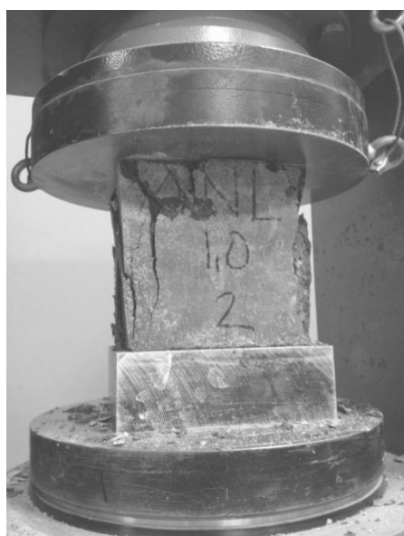
Figur 34. Tryckprovning av Anl 1,0 \text{ kg/m}^3
