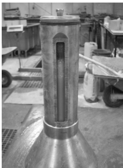
Figur 23. Roll-A-Meter. Total lufthalt 3,5 %
