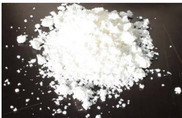
Figur 17. SikaAer Solid, små plastkulor i storleken 10-100 µm.
