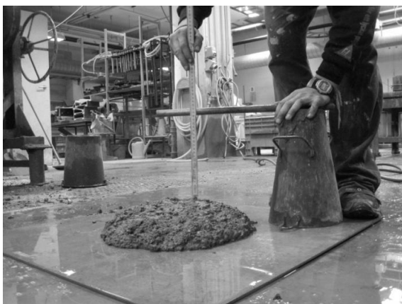
Figur 28. UV ref sättmått (60min) 225mm
