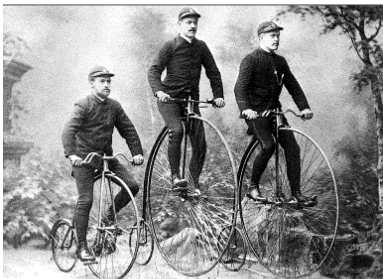
Figur 4 T.v. känguruvelociped med kedjedrivning på framhjulet, t.h. två höghjulingar. Ur "Älskade cykel" (2001)
