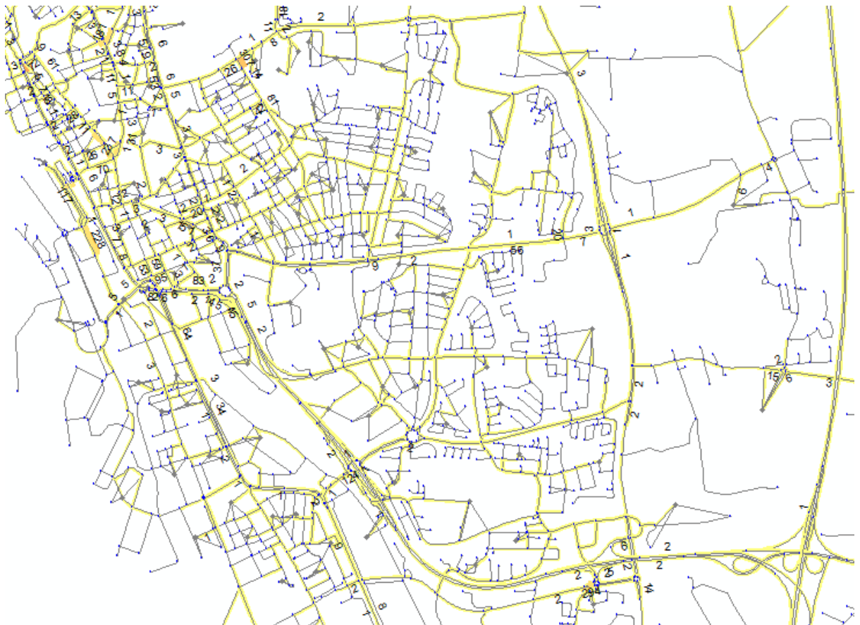
Figur 35. Kövolymen i södra Helsingborg, scenario 2. Malmöleden har ungefär samma kömängd som i ursprungsscenariot.
