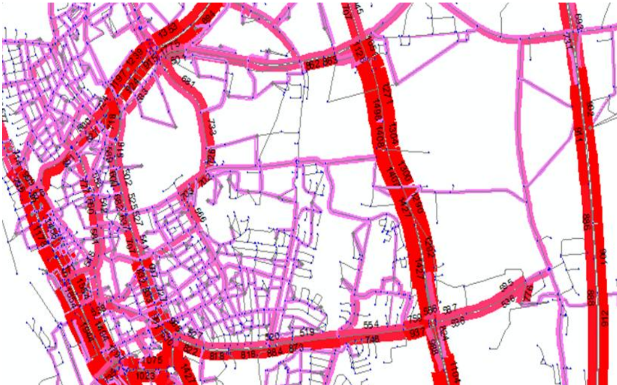
Figur 24. Visar fordonsflödet på vägarna i norra/centrala delen av Helsingborg i ursprungsscenarioet, det vill säga med tripendmatrisen som används i modellen.
