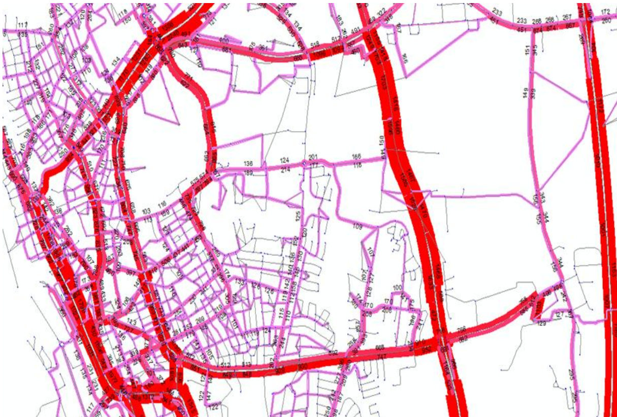
Figur 28. Fordonsflödet i norra/centrala delen av Helsingborg i scenario 1. Flödet har minskat något på Drottninggatan och ökat något på Stenbockgatan/Ringtorpsvägen, Österleden och E22/E6 även fast bandbredden som indikerar fordonsflödet ser ut att ha avsmalnat.
