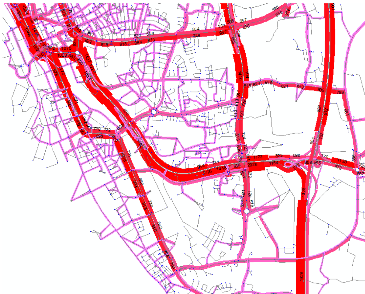
Figur 25. Fordonsflödet i södra delen av Helsingborg i ursprungsscenarioet, det vill säga med tripend matrisen som används i modellen.
