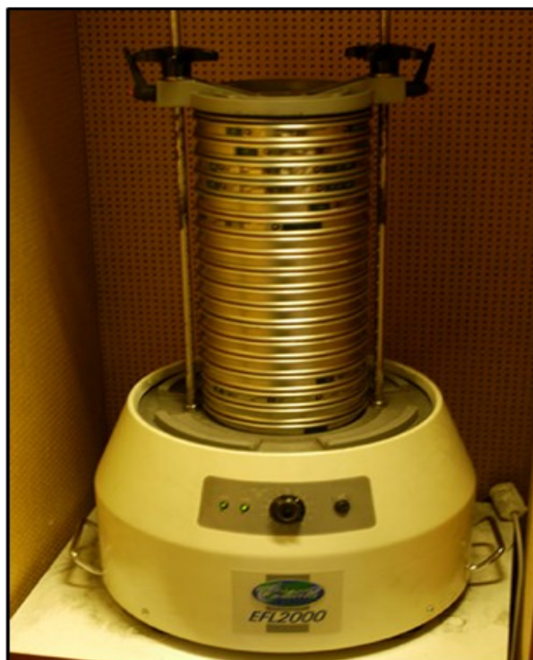
Foto. 2 .Siktstapel med tillhörande skakmaskin som används till kornstorleksanalyser (Foto av Jari Leskelä 2012)
