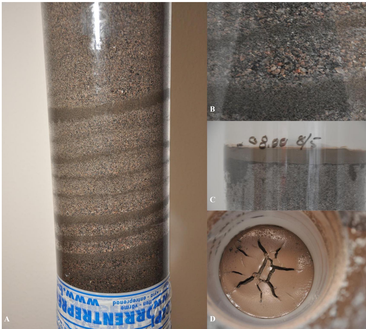
Foto. 7A. Cylindern från experimentet som visar separationen. Foto. 7B. Sektion av cylindern som visar ett område med grövre sediment. Foto. 7C. Toppen av Cylindern som visar det finkorniga lager vilket bildats vid experimentet. Foto. 7D. Torrsprickor i de finsediment som bildats av separationen (Foto av Jari Leskelä 2012).
