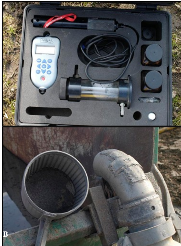
Foto. 8A. Aquaread AP-900 vilken använts vid brunnsdokumentering. Foto. 8B. Metallhåv vilken använts vid provtagning av borkkax. (Foto av Jari Leskelä 2012).
