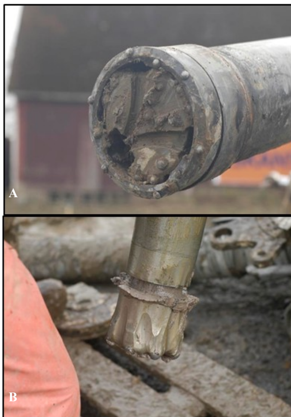
Foto. 9A. Atlas ringborrkrona vilken användes vid borrning av de kvartära avlagringarna. Foto. 9B. Borrkronan DTH (Down The Hole) som används vid borrning av de sedimentära avlagringarna (Foto av Jari Leskelä 2012).
