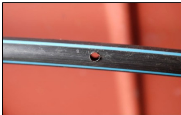
Foto. 4. Slang med tillverkade hål för täthetsmätning av stenmjöl (Foto av Jari Leskelä 2012).
