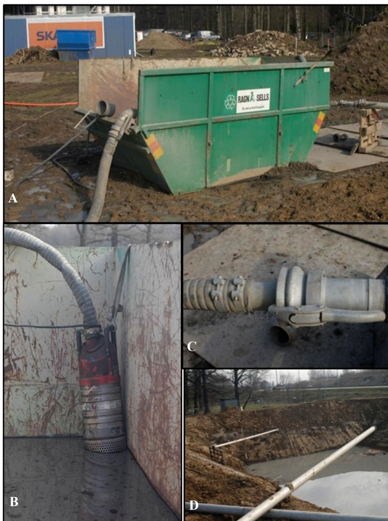
Foto. 10A. Slangen varifrån vatten och borrhåll från brunnen bärds i på väg ut till containern där borrhåll och vattenprov tags från. Foto. 10B. Pumpen som för vattnet från container ut till reservoar. Foto. 10C. Koppling varifrån blåskapacitet mäts. Foto. 10D. Pumpens utlopp där brunnen vatten samlas i reservoaren (Foto av Jari Leskelä 2012).
