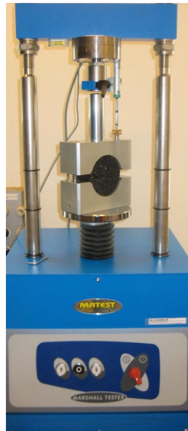
Figur 3-6: Marshallpress med presshuvud och provkropp.
