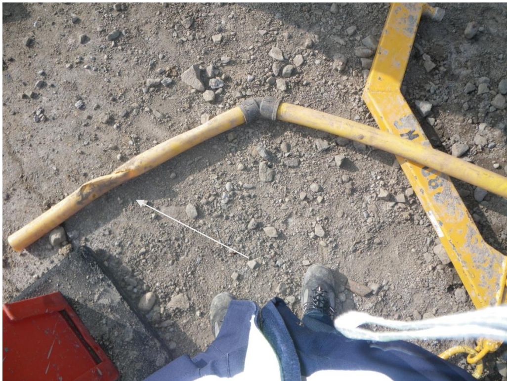
Figur 9, Bilden visar böjen som ledningen gjorde. Pilen pekar där gasen läckte ut. Foto: Andreas Kroon
