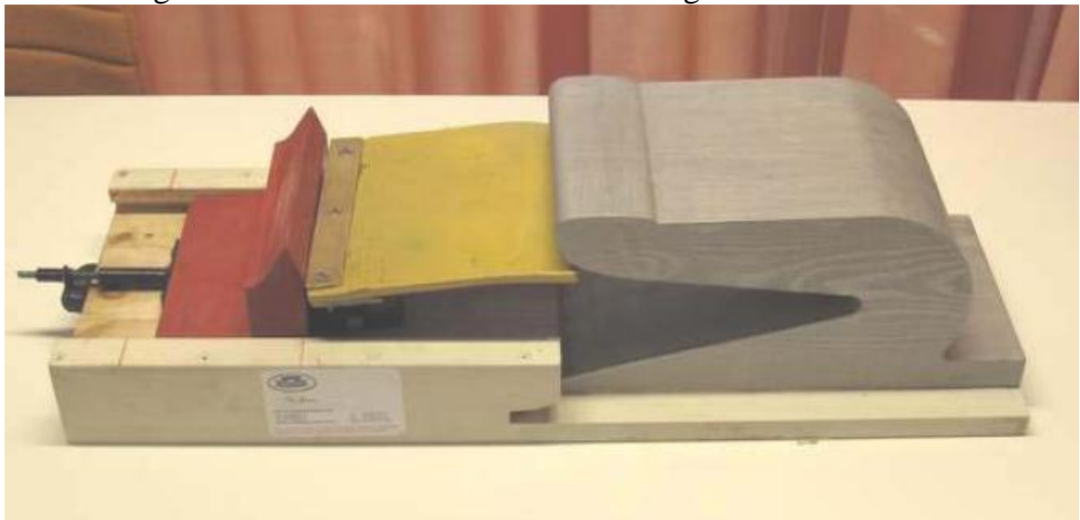
Figur 15 Trämodell av specialräl och gummiläpp. (SL 2010)
