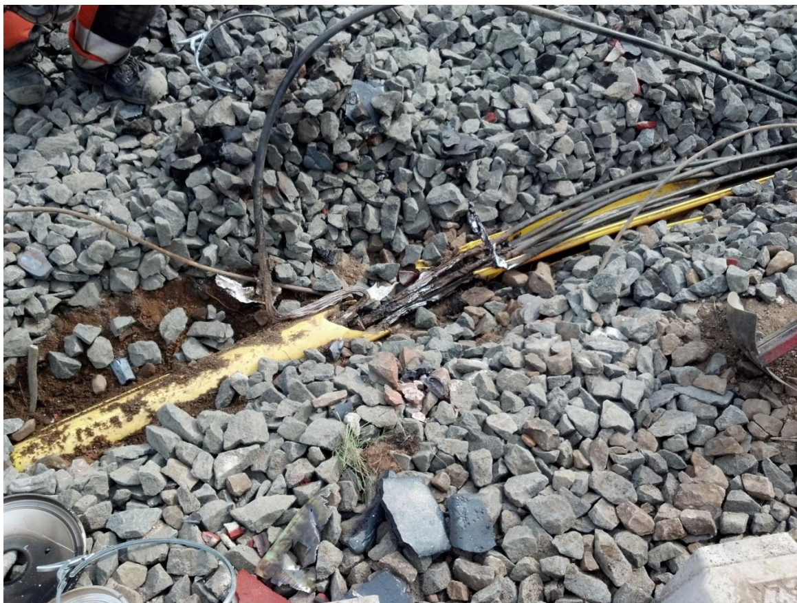
Bild 14: Kablarna som hade smält samman där termitöverskottet hade slängts
