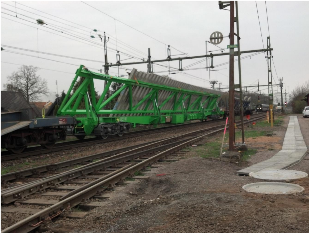
Bild 6: De nya växlarna som transporteras horisontalt
