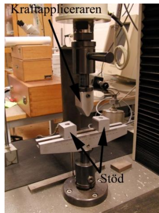
Figur 26: 3-punktsböjtest. På bilden ses de två stöden och den höj- och sänkbara "kraftappliceraren".
