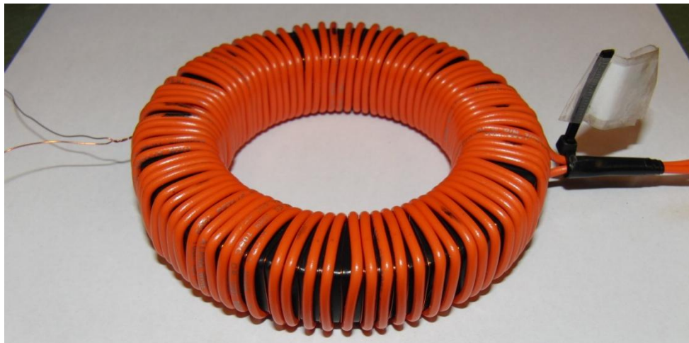
Figur 32: Toroidformad testkropp lindad med exciteringslindning (orange) och "pick-up-lindning" (kopparfärgad).
