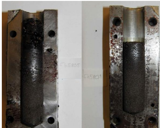
Figur 24: T.v. Resultat från härkning av PA5803L. T.h. Resultat från härkning med läckande gjutform.
