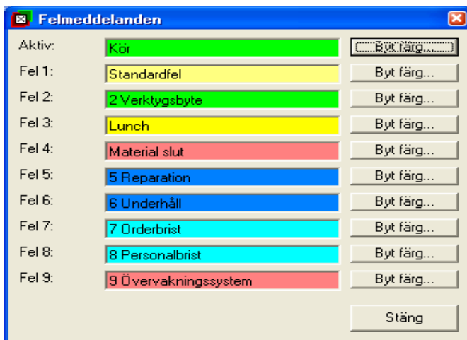
Figur 4.3.4: Olika färger indikerar olika status eller stoppsaker på maskinen för att sedan visas i MUR Server. 1
