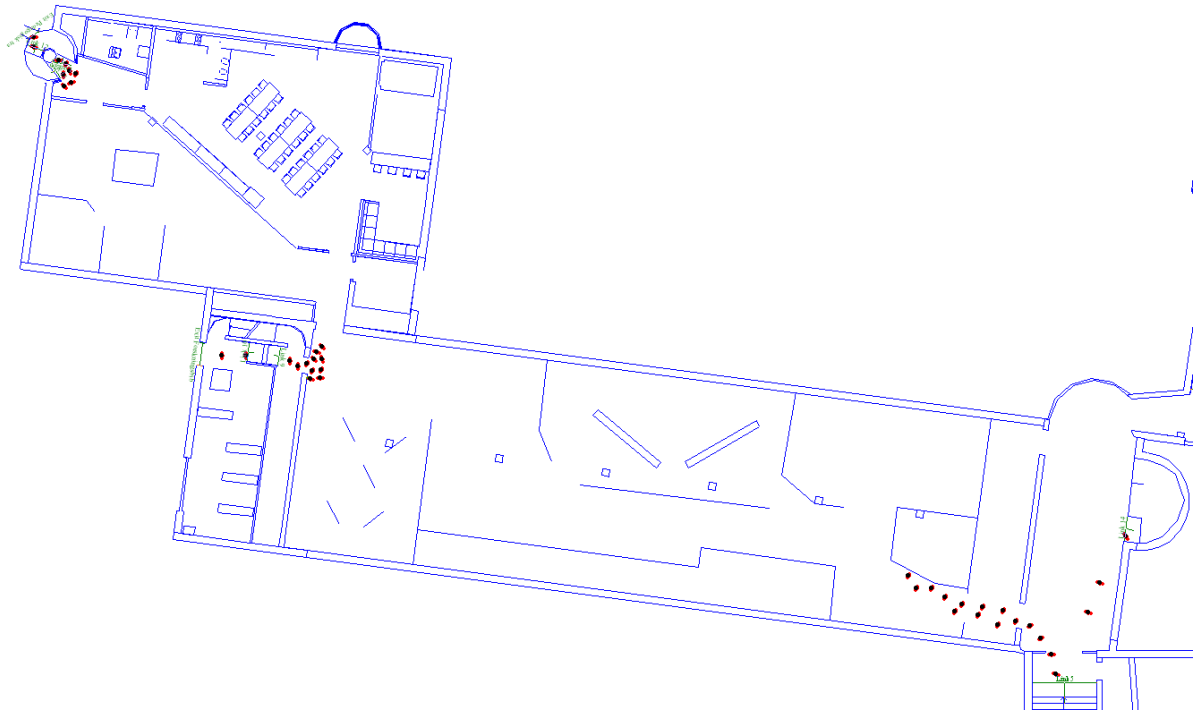
Figur G.9 Bild av utrymningsscenariot 3.6 med normalt antal personer i nedre utställningshallen (nedre plan). Bilden är tagen från en simulering i SIMULEX. Problematiskt område uppstår nära trappan i forskningsbiblioteket.
