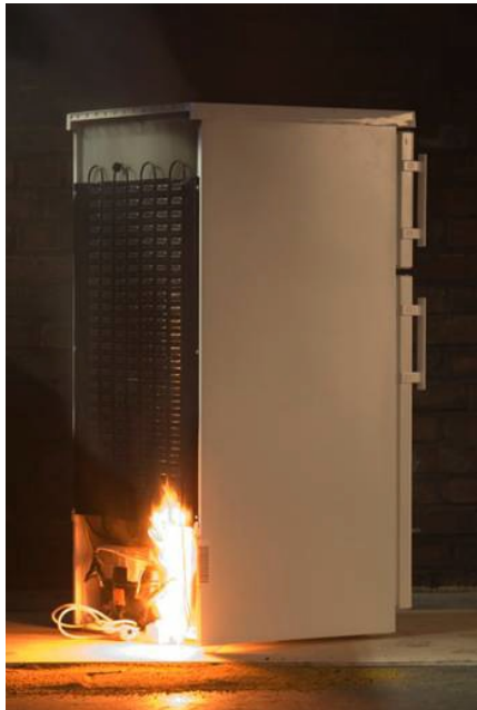
Figur 6.3. Brand i kylskåp fem minuter efter antändning (Beard & Goebelbecker, 2007).
