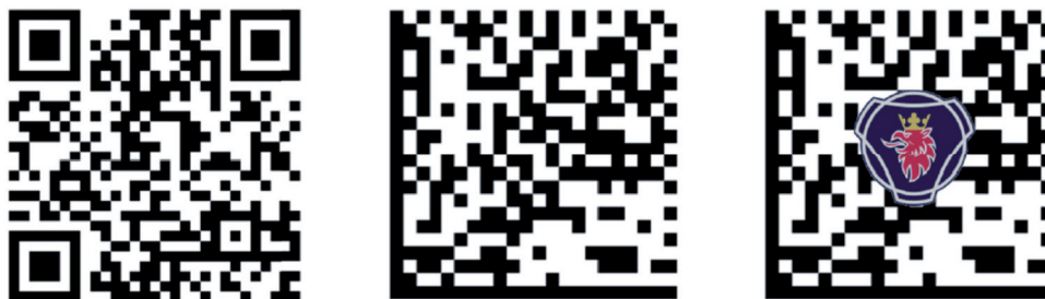
Bild 8: QR-kod respektive oskadad och skadad ECC 200 Datamatrix. Alla koder är läsbara och har samma innehåll.
