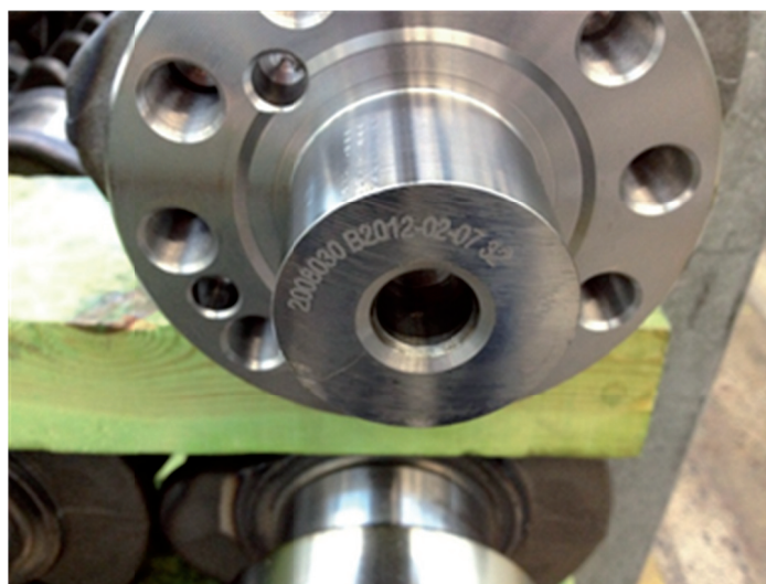
Bild 12 En vevaxels nålpräglade märkning.
