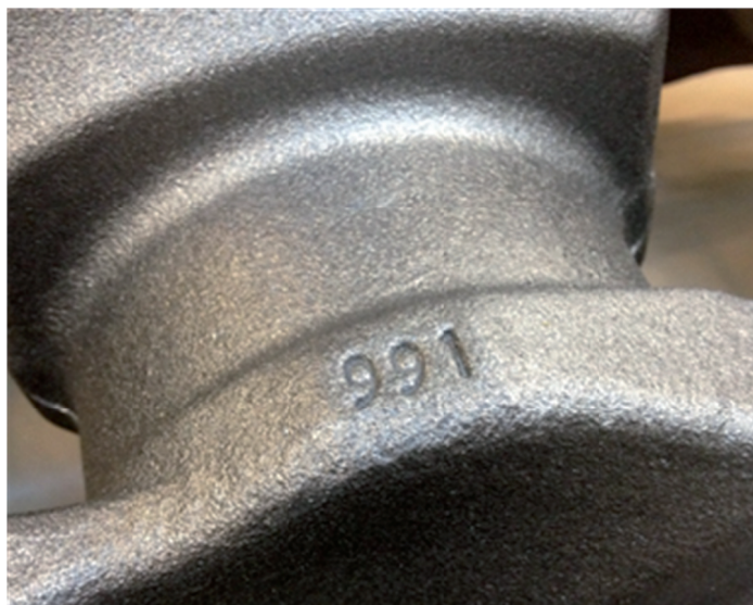
Bild 11 Smidets batchnummer på en vevaxel.
