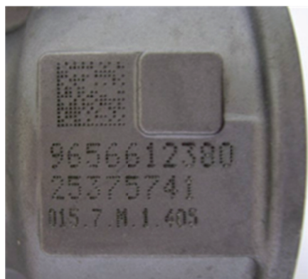
Bild 25, [23] Datamatrix märkt med i81-A.
