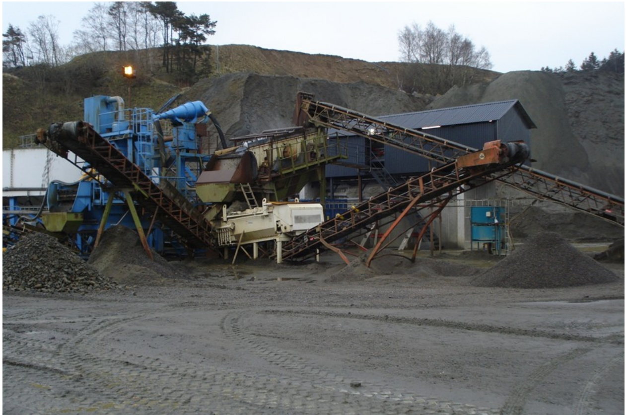
”Figur 7 ger en helhets bild av processen. Den vita delen i mitten (scrubber) är där siktningen av materialet i 4-16mm sker. Till vänster om den vita tvätt enheten kan man se det sorterade grova materialet och till höger kan man se 4-16 mm. Bild Fredrik Nylén
