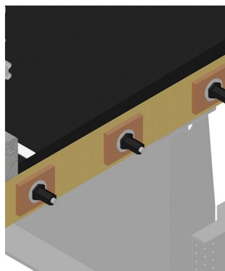
Figur 2.11: Principskiss spänning av ståltag.
