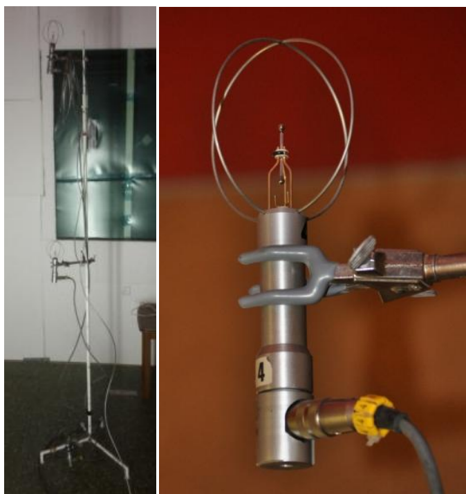
Figur 14 - Stativ med sensorer som registrerar lufttemperatur och luftfartighet.
