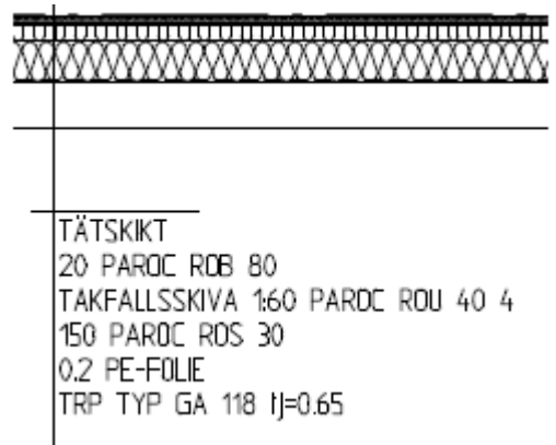
Figur 3.7 Sektionsritning över bostadstaket
