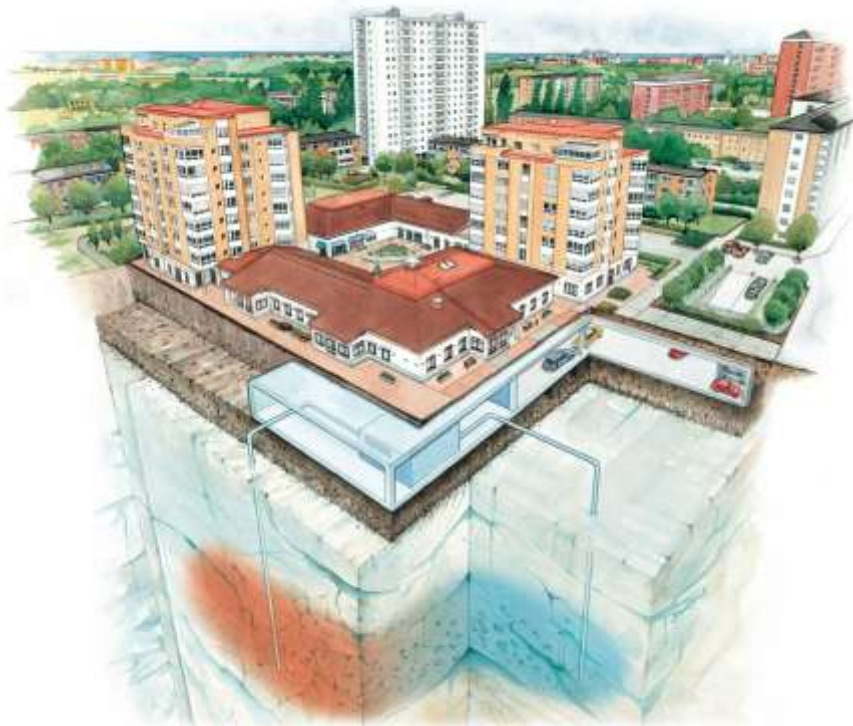
FIGUR 2. AKVIFERLAGER. BILD FRÅN GEOTEC. (GEOTEC, 2011)
