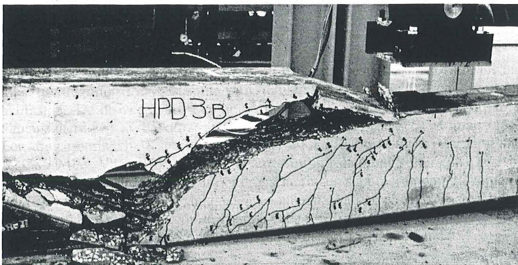
Foto 6.8 Balk HPD3B efter brott.
