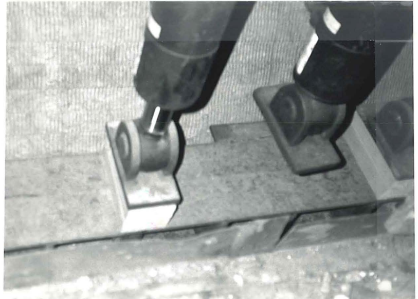
Fig. 47: Påföring av lasten skedde med hudrauliskolv via tråkloss, stålbalk och liggande träregel.
