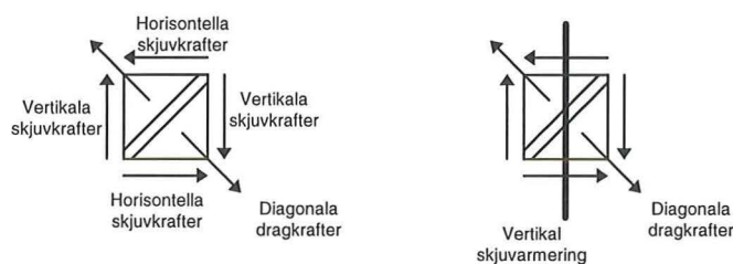
Figur 3.4 Skjuvning på balkelement (Referens 7)
