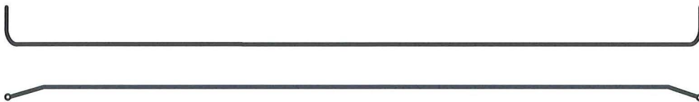
Figur 4.3 Utformning av den horisontella armeringen. Den övre bilden är sett från sidan och den undre är sedd ovanifrån.
