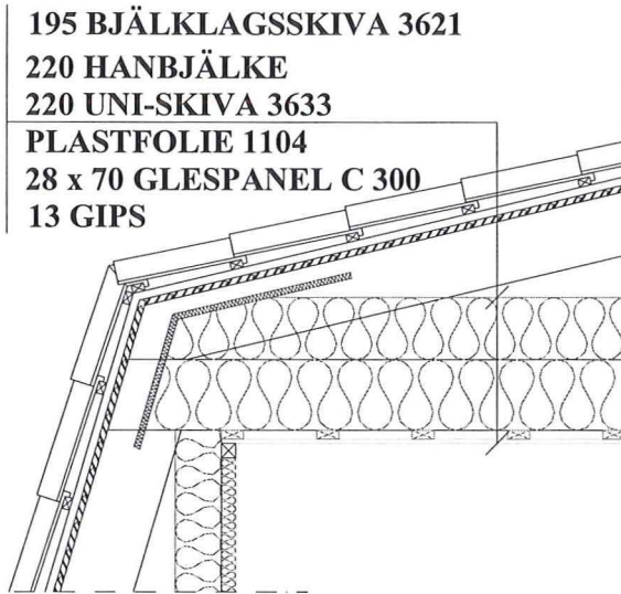
Figur 13. Anslutning stödbensvägg/hanbjälklag
