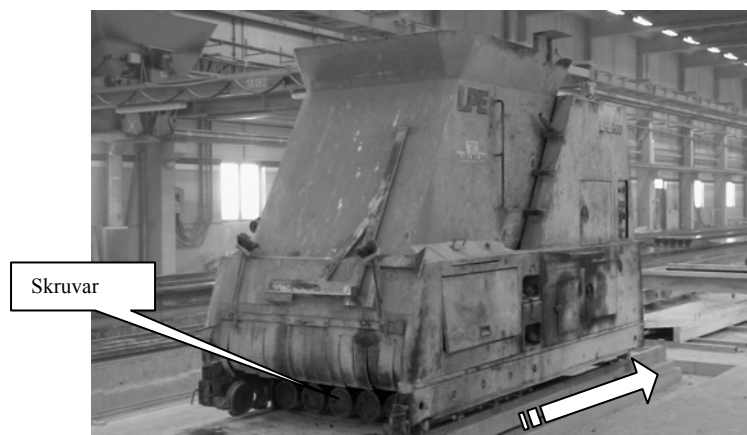
Figur 1.3. Bild av glidgjutmaskin (Pilen visar rörelseriktning).
