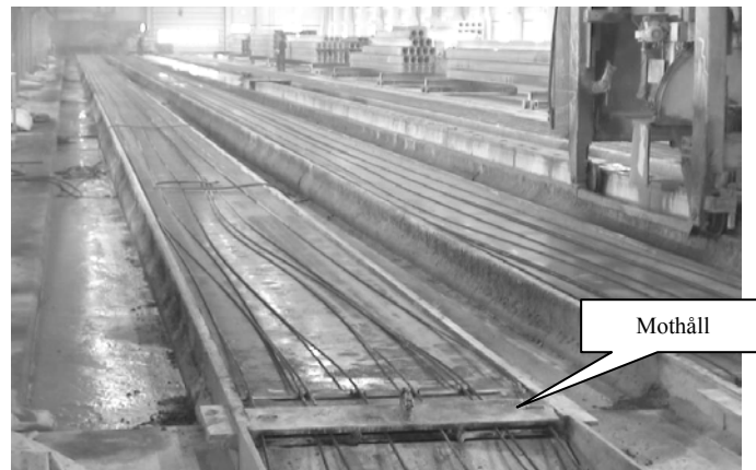
Figur 1.2. Bild av spännbädd med mothåll.
