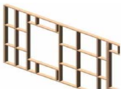
Figur 3.6 Exempel på regelstruktur i vägg skapad i Coins Framing (Coins Ltd 2005-06-30 a)
