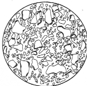
Figur 2-4 De mörkare parterna visar exempel på mikrosprickor. Källa: Petersons 1994
