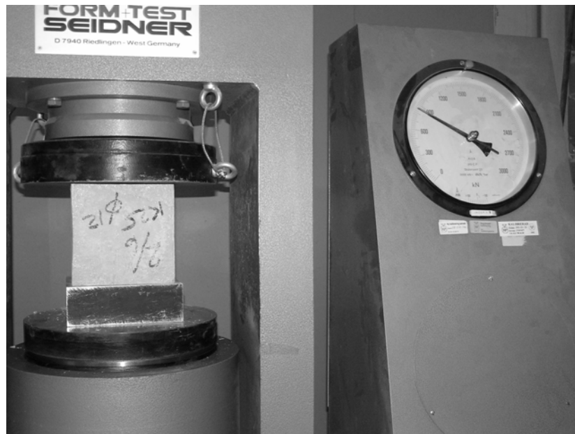
Figur 4-7 Försöksuppställning för bestämning av tryckhållfasthet
