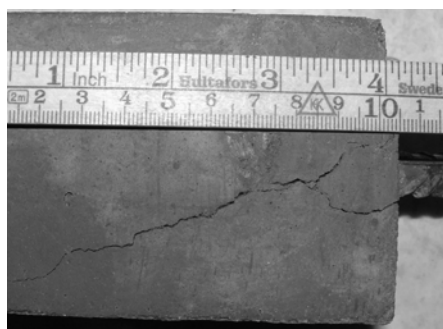
Figur 5-4 Spricka bildad vid avformning, plan.
