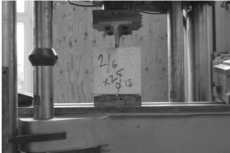
Figur 4-6 Försöksupställning för bestämning av spräckhållfasthet
