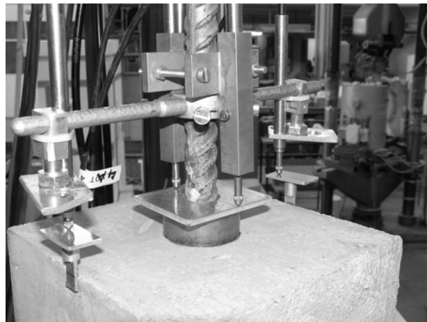
Figur 4-14 Provrigg och LVDT-givare monterade på änden av en provkropp
