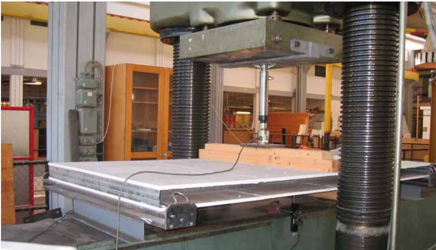
Figur 10 Linjelast på spontvägg
