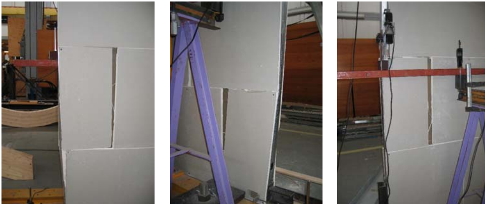
Figur 19 Spontad vägg - brott i limfog mellan skivor vid vägglut
