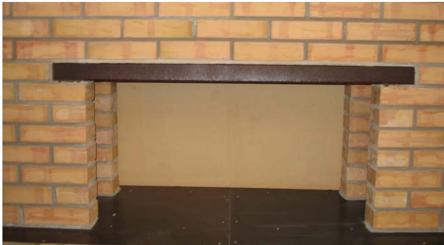
Figur 4-4. Fullskalemodell av liggande VKR-stålprofil. Öppningsbredd: 1,0 m. Balklängd: 1,25 m.
