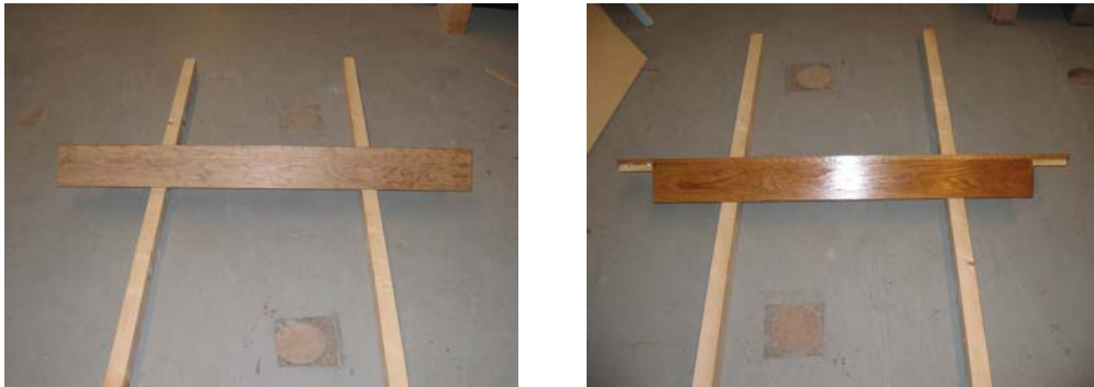
Figur 4-23. Fronten till UPE- profilen före och efter behandling med linolja. Bilden till vänster visar framkanten obehandlad och bilden till höger visar underkanten nystruken med linolja.
