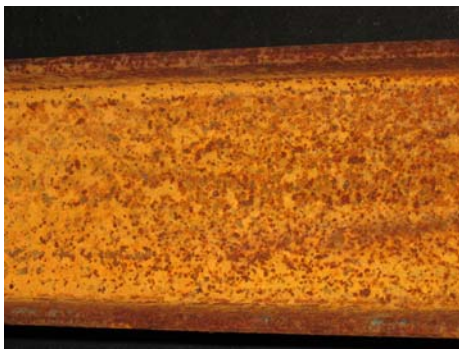
Figur 4-11. I-profil efter behandling med saltsyra.
