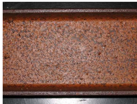
Figur 4-12. Samma I-profil efter behandling med linolja, en strykning.
