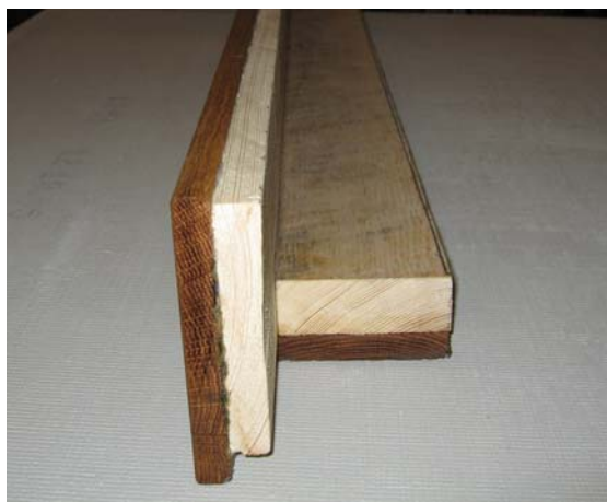
Figur 4-16. Träfronten i profil efter limning och behandling med linolja.
